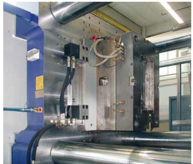
Клиновые зажимы с усилием зажима 160 кН на машине литья под давлением Windsor W 550
