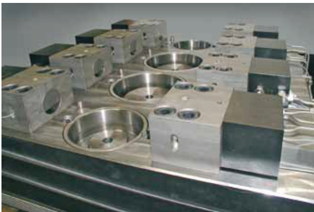
Клиновые зажимы для штампа для горячей штамповки, температура 250°C
