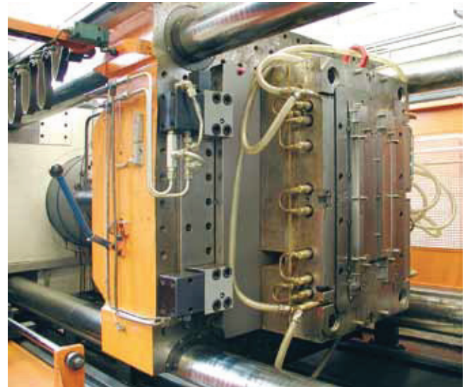
Клиновые зажимы с обратными клапанами на машине литья под давлением Krauss Maffei KM 575
