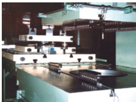
Двухавровые зажимные планки на столе и ползуне прессы
