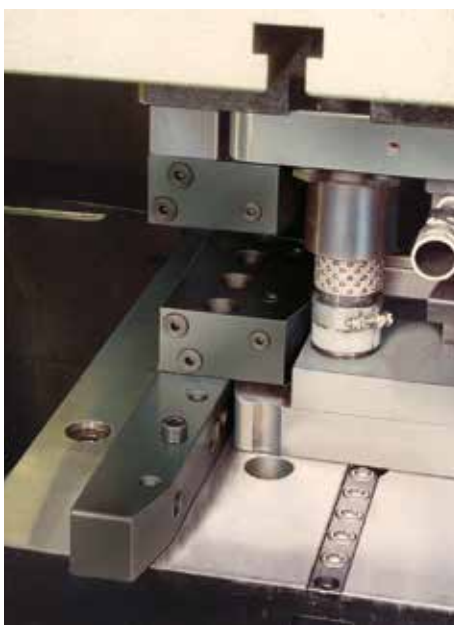
Модернизация двухколонного пресса. Простая установка штампа в пресс благодаря использованию зажимных планок со скошенными кромками и шариковых направляющих.
