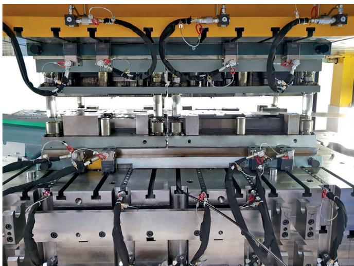
Вставные зажимы в комплекте с подставками для установки в Т-образный паз, закрепленные на столе и ползуне пресса
