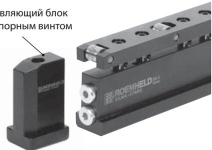
Если боковое смещение штампа является значительным (до 1,5 мм), или если штамп устанавливается в пресс не со стороны гидравлического подсоединения зажимной планки, то рекомендуется использование направляющих блоков. Они фиксируются в Т-образных пазах посредством стопорных болтов. Специальные исполнения направляющих блоков доступны по запросу (например, исполнения с гидравлическими подсоединениями).
