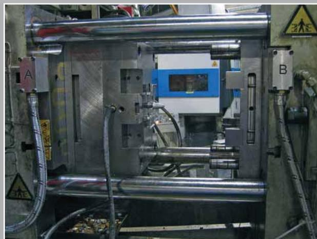
Система магнитного зажима, установленная на машине для литья под давлением СС125; замыкающее усилие 1500 кН, температура до 230°C
