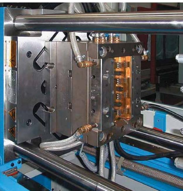
Термопластавтомат с применением M-TECS 130
