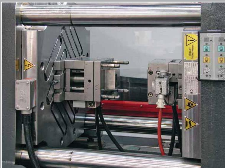
Обеспечивается надежный зажим даже самых малагабаритных штампов. За счет удлиненного полюса создается максимальная концентрация магнитного поля, передающегося на базовую плиту штампа. Комплекс оборудования FM 110 Electra, магнитная сила - 8 тонн
