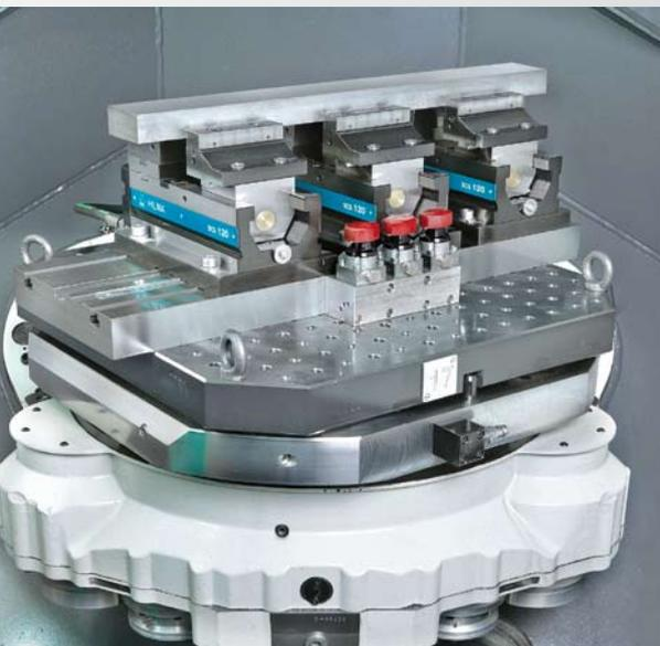
Трое тисков SCS 120 H, установленных на паллете. Сила зажима контролируется гидравлически.
