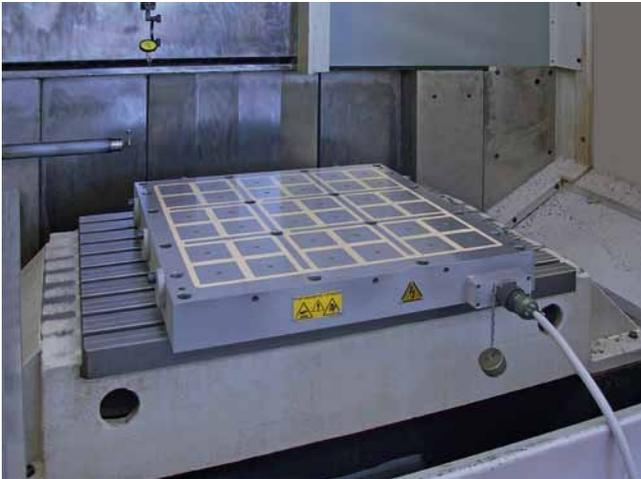
Магнитные зажимные плиты с квадратными полюсами 70 x 70, размер плиты 630 x 630 мм, отверстия по бокам для стопорных планок
