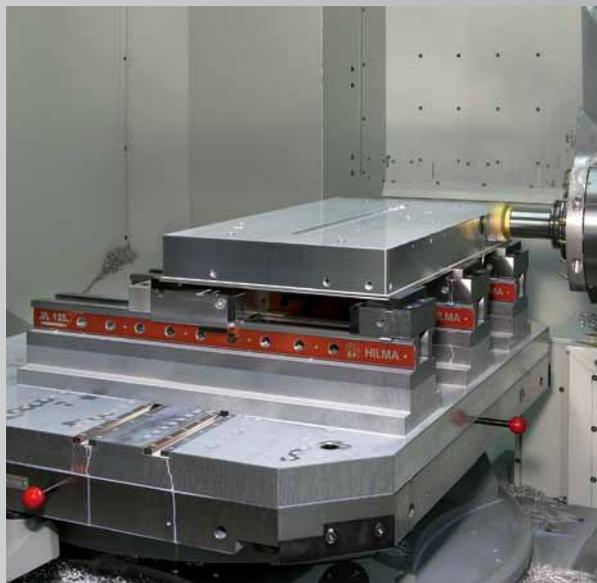
Зажим заготовки типа плиты на трех машинных тисках
