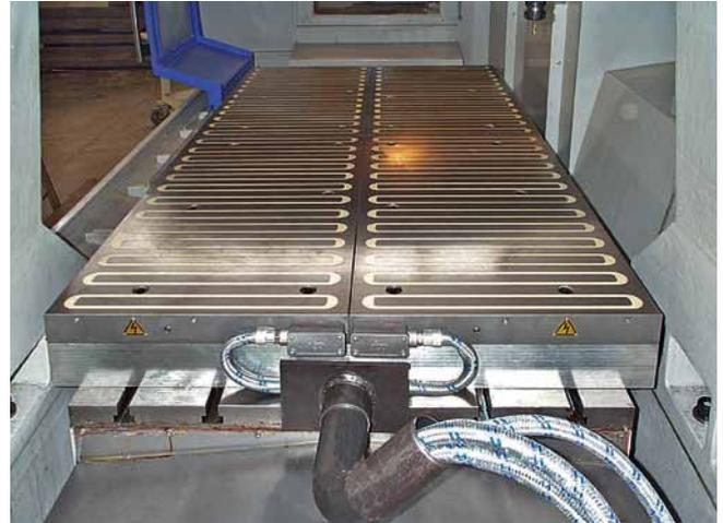
Длинные полюса для тяжелых условий обработки, размер плиты 2200 x 1200 мм, 2 подключения, магнитная сила удержания 800 кН.
