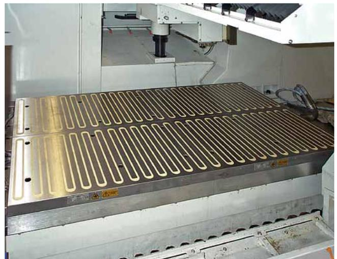
M-TECS с длинными LP полюсами с концентрацией мощности для очень малых пресс-форм.
