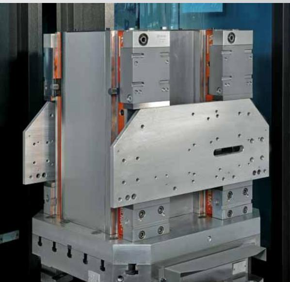
Машинные тиски Varioline на зажимной башне для обработки крупных деталей
