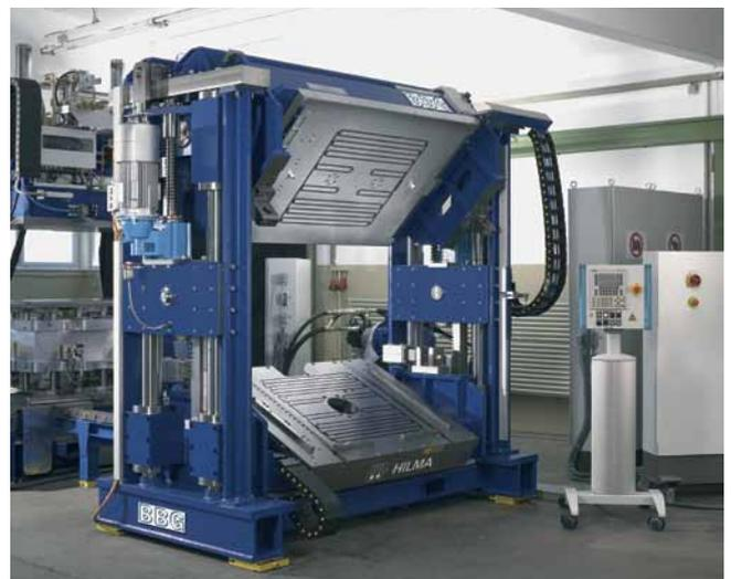
Магнитная зажимная система на несущем устройстве для пресс-форм, размер 1500 x 1000 мм, сила удержания 200 кН, раб. температура до 120°C
