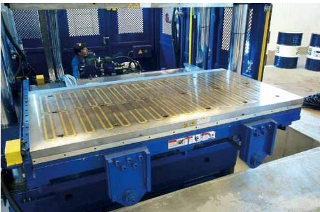
Магнитная зажимная система на выкатном столе 2500 x 1200 мм, сила удержания 800 кН, рабочая температура до 230°C
